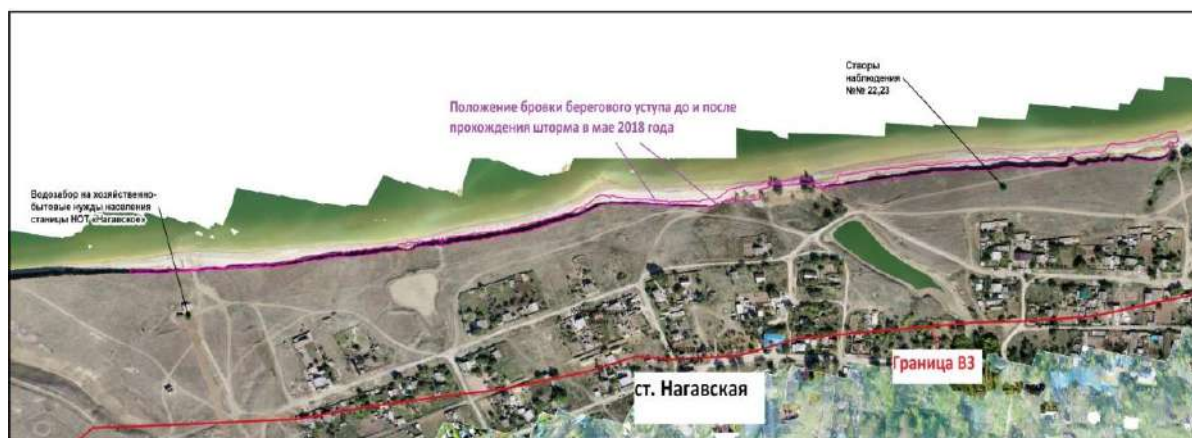
Рисунок 4.19 - Положение бровки берегового уступа до и после прохождения шторма в мае 2018 года на территории ст. Нагавская Котельниковского района Волгоградской области.
