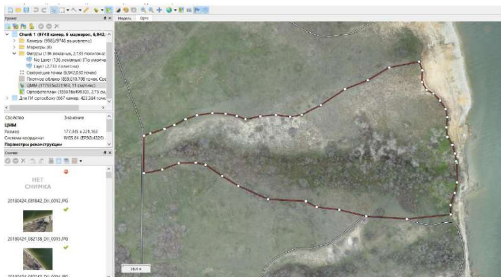
Рисунок 4.34. – Пример выделение площади оврага на ортофотоплане в программе Agisoft PhotoScan Professional.
