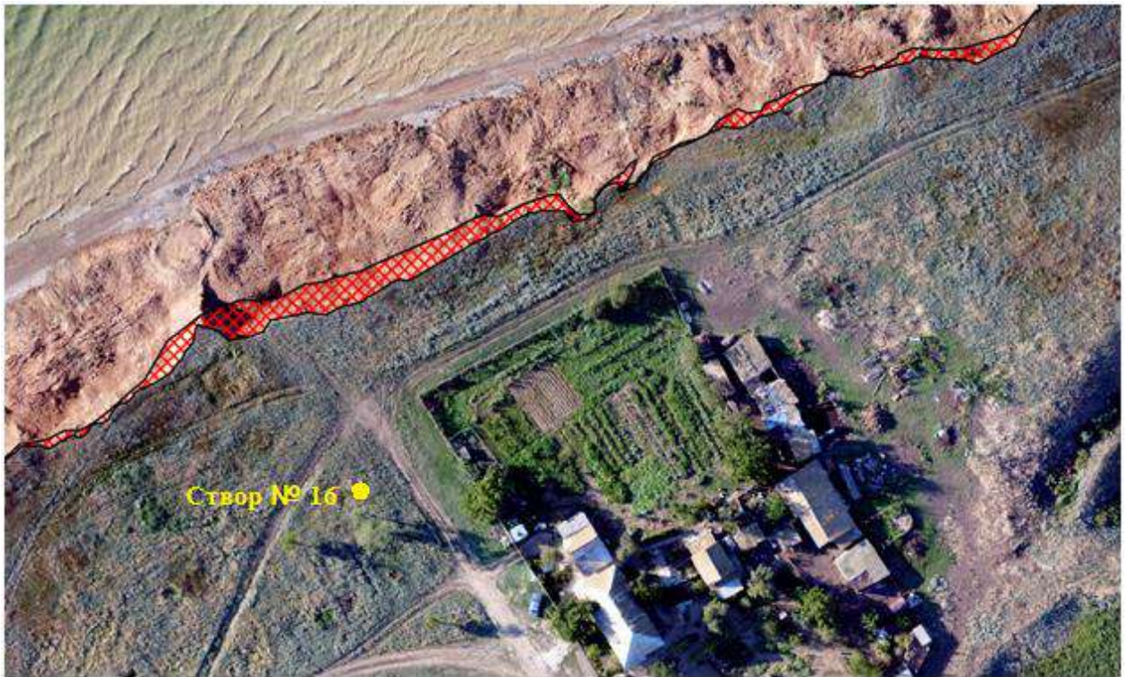
Рисунок 4.15 - Отступление бровки берегового обрыва за период с сентября 2018г. по август 2019 г. в районе створа № 16 сети ГМВО.
