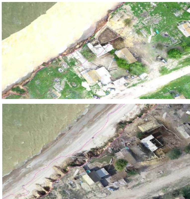
Рисунок 4.20 - Фрагменты ортофотопланов территории жилой застройки в х.Весёлый с маркировкой положения бровки берегового уступа: вверху - до шторма, внизу - после прохождения шторма.
