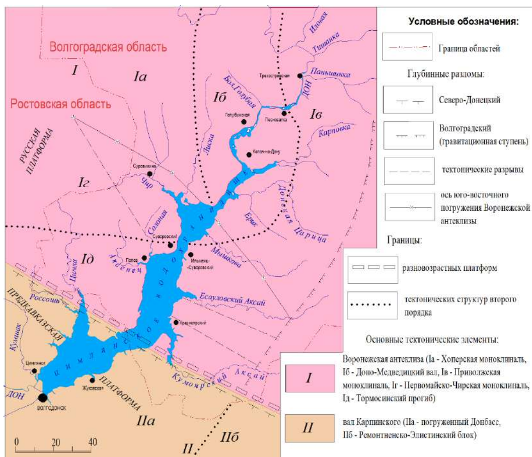
Рис. 1.2 Тектоническое строение территории, прилегающей к Цимлянскому водохранилищу (по Погребнов Н.И., Потапов И.И. 1962).
