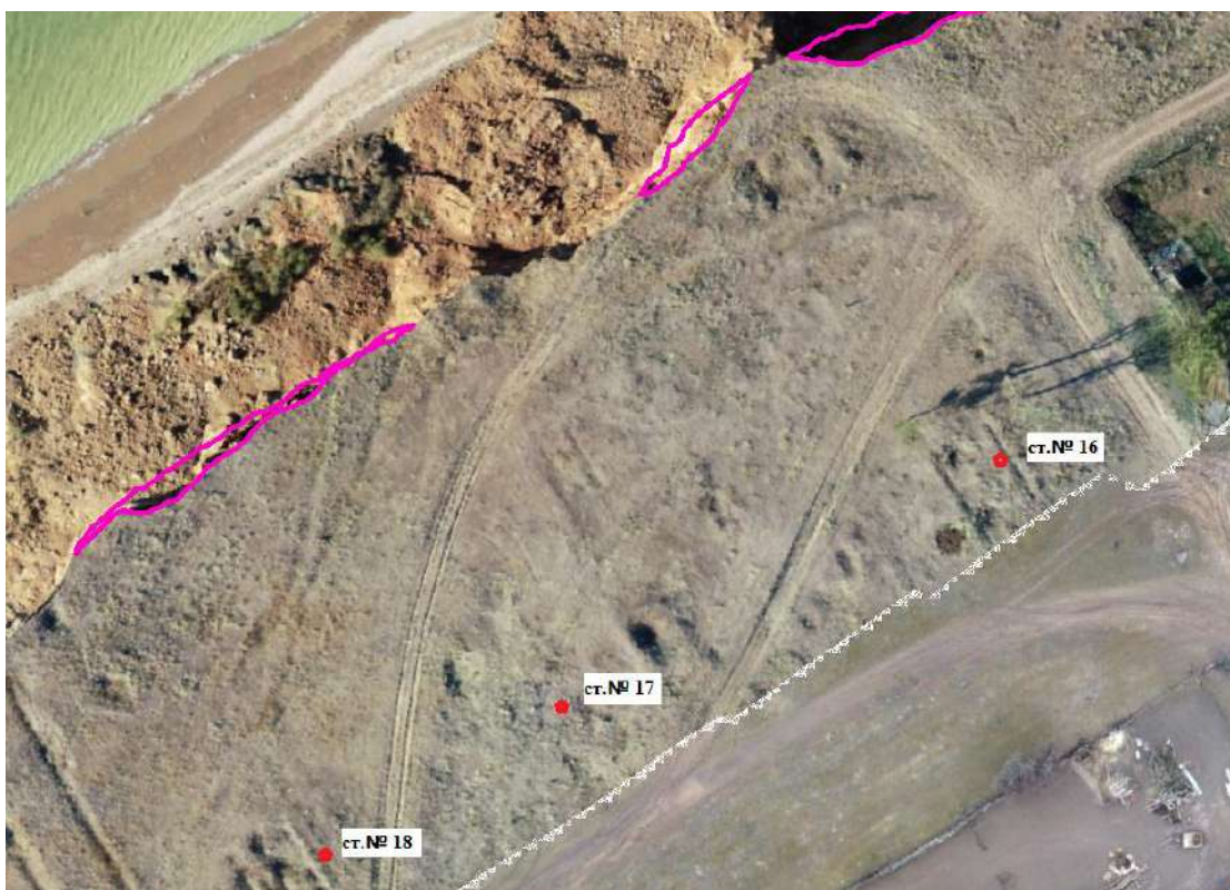
Рисунок 4.13 - Расположение блоков горных пород, обрушившихся в период с марта 2018 года по август 2018 года, относительно створов сети ГМВО.
