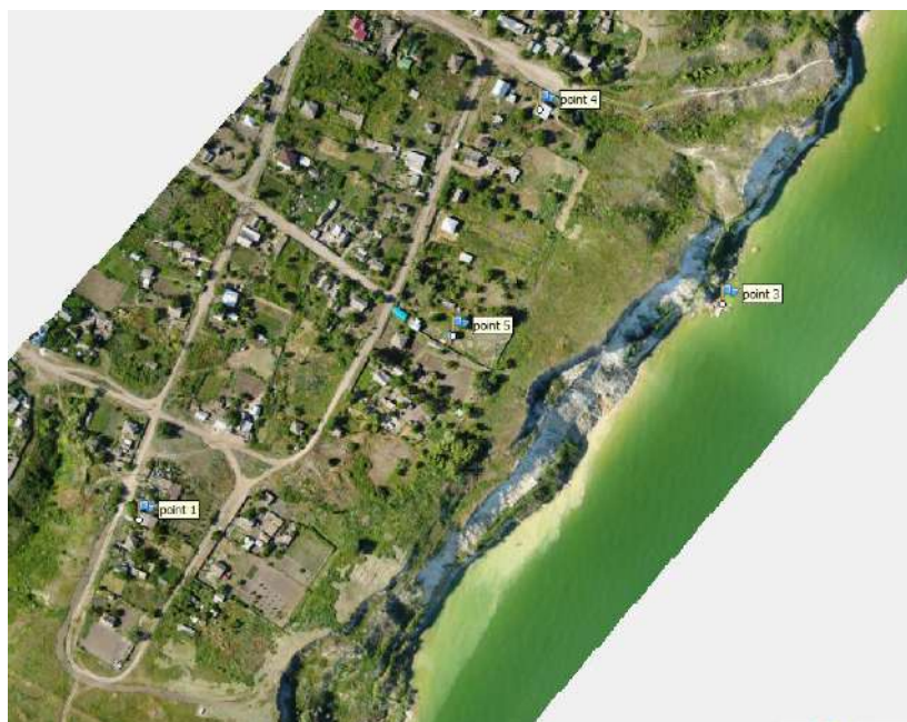
Рисунок 4.3. - Фрагмент ортофотоплана с расположением опорных точек, использованных для их взаимного позиционирования.
