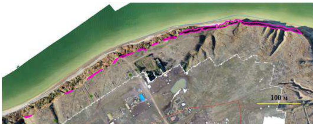
Рисунок 4.11 - Границы блоков горных пород, разрушенных в результате проявления ЭГП на восточной окраине х. Кривский в период с марта 2018 г. по август 2018 г.
