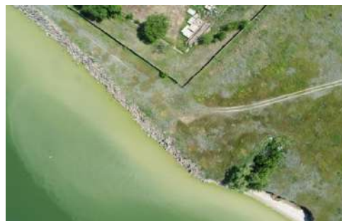
Рисунок 3.18 – Пример техногенных берегов Б) Каменная наброска х. Овчинников.
