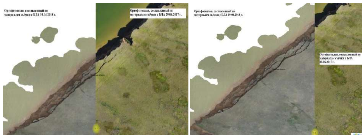
Рисунок 4.1. - Сопоставление "методом сдвига" материалов обследований блокового оползня на берегу Цимлянского водохранилища, полученных с использованием беспилотного летательного аппарата.
